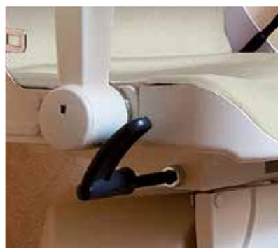
Levier de commande pour manœuvrer la rotation du siège
